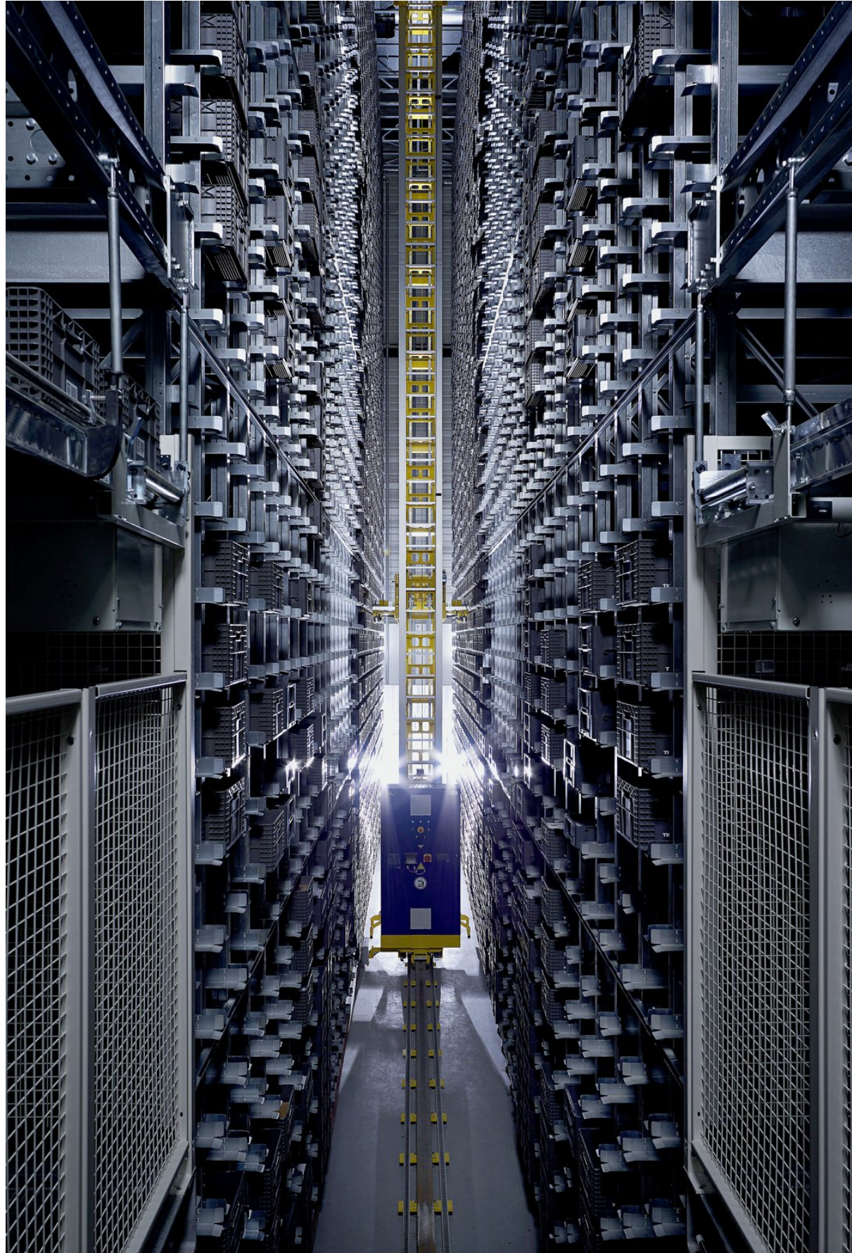
Plus de 5 millions de montres et de composants sont classés, sortis, rentrés, chaque année, par cinq robots. D'un point de vue humain, la méthode est anarchique, puisqu'elle ne se base sur aucun classement «logique» (par marque, par ordre alphabétique, etc.). Le personnel se charge de l'étiquetage et du tracking.
